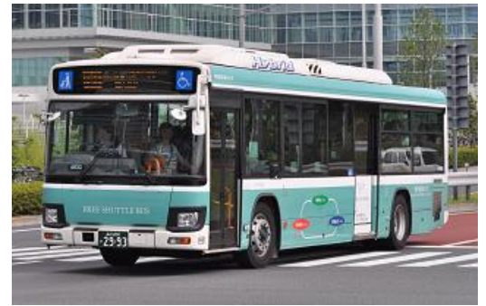
最近の路線バスで主流となっている「ノンステップバス」。写真の車はさらにハイブリッド車となっています。
